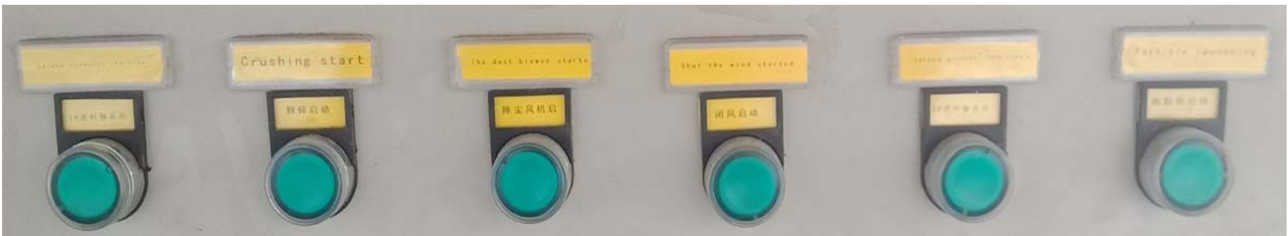
1#进料输送启动 粉碎启动 除尘风机启动 闭风启动 2#进料输送启动 制粒机启动 4 1 2 3 7 6
